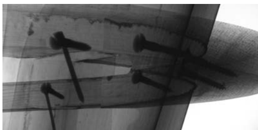
Afbeelding 18 Rugleuning geschroefd tegen armleuning. Röntgenfoto: DP 435 Vario V32.7, 86 kV, 2.8 mA, Me filter. Foto: Tonny Beentjes.
