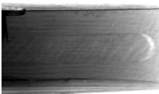
Afbeelding 17 Verbinding zittingsegmenten met losse pen, voor-kant. Röntgenfoto: DP 435 Vario V32.7, 86 kV 2.8 mA Me filter. Foto: Tonny Beentjes.
