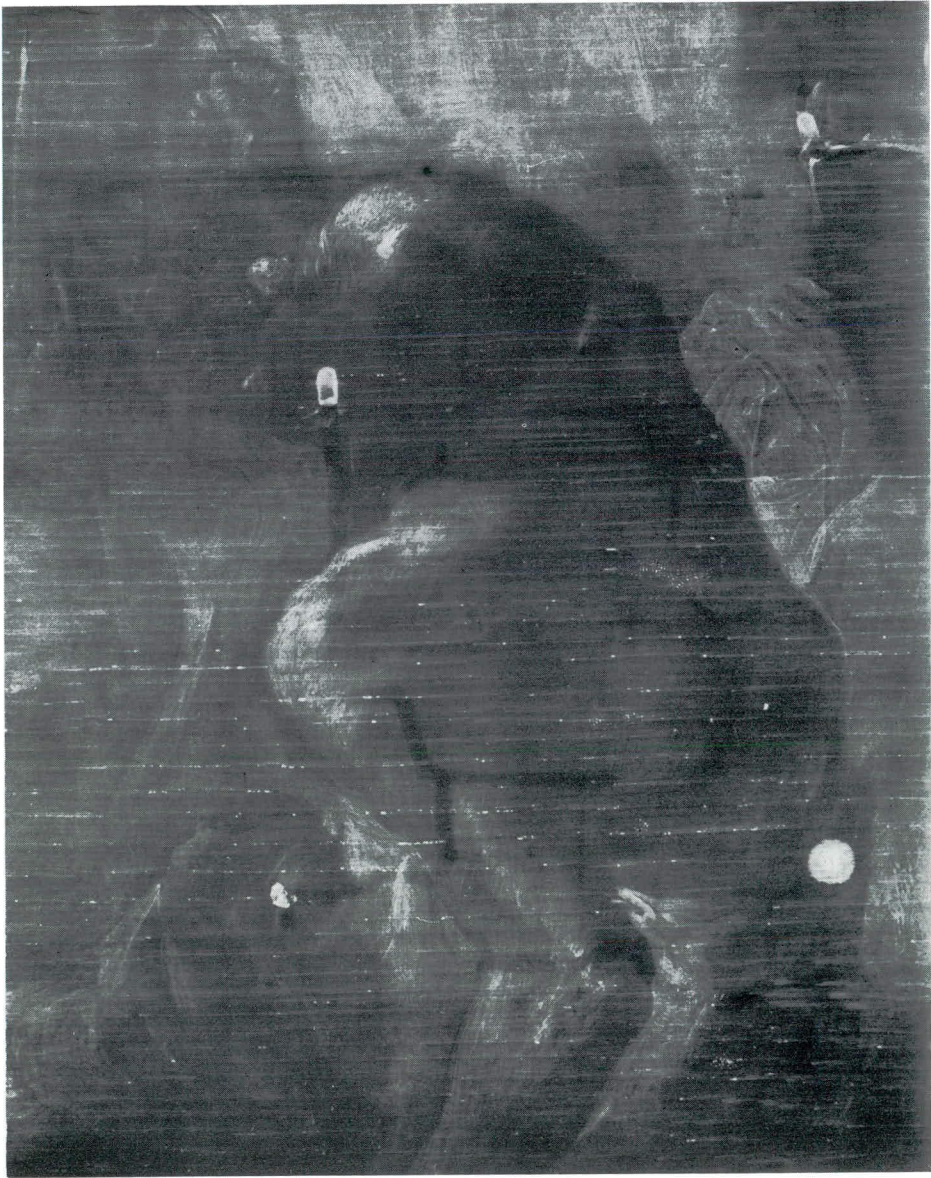
Afb. VIII Röntgenfoto van een detail uit „St. Maarten en de bedelaar” door Maarten Stoop (cat.nr.272). De donkere strepen stemmen overeen met de boorgangen van de larven van het doodskloppertje ( Anobium punctatum de Geer).
